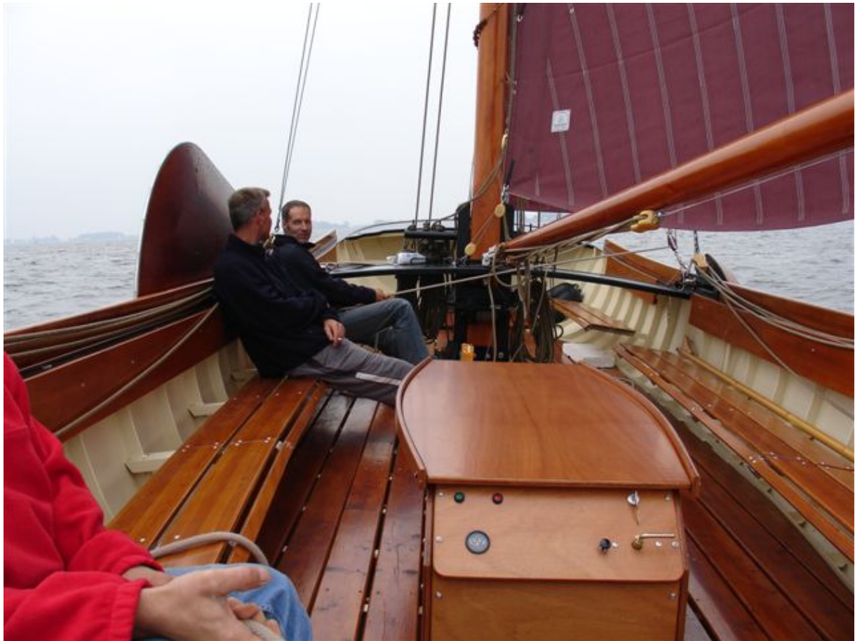
Een Nije Sylpream van Victor van IJzendoorn. In de kuip de kast om de scheepsmotor. (Foto: IJzendoorn jachtbouw).
