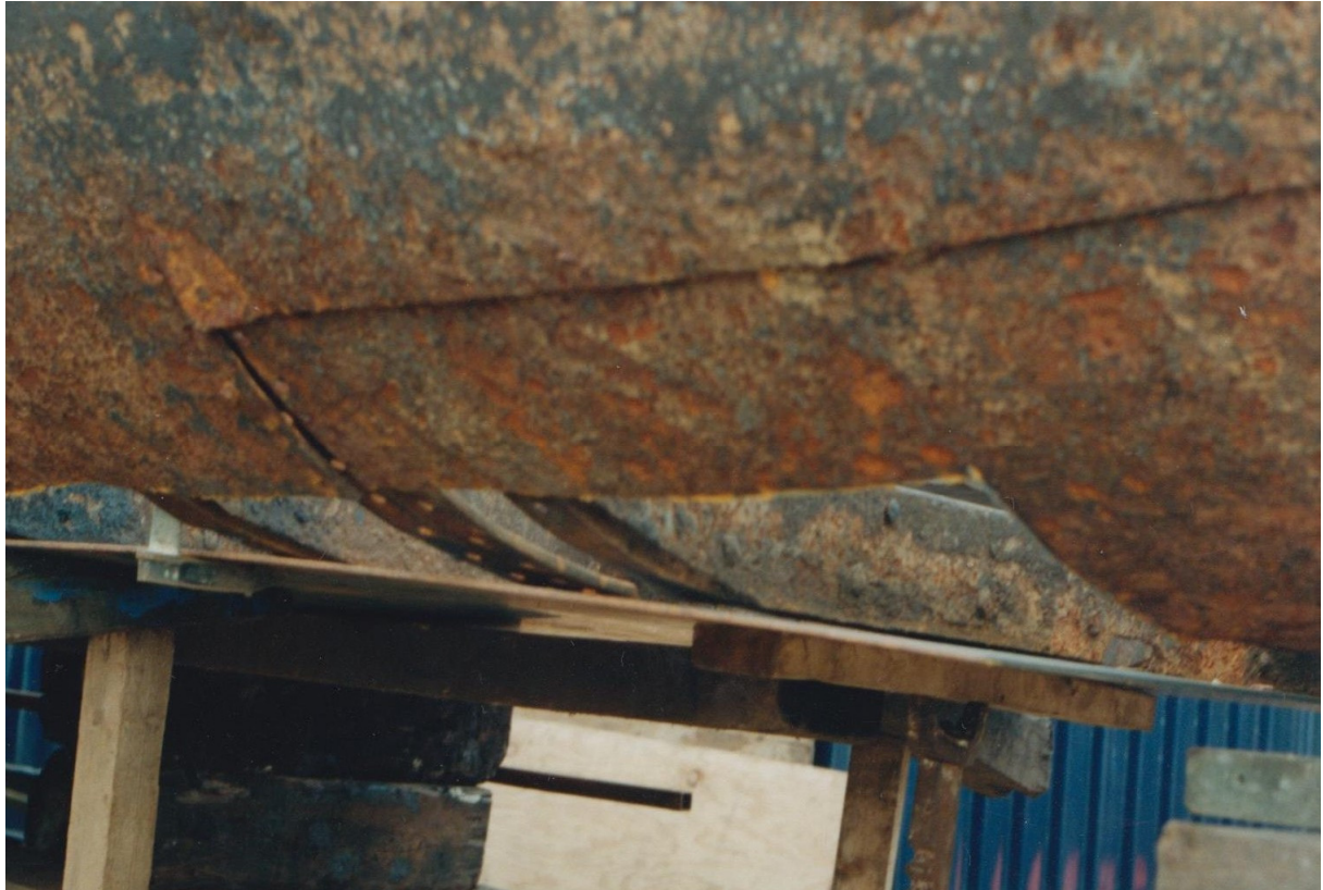
Roestvorming heeft z'n werk gedaan. Delen van de romp moeten worden vervangen door nieuwe staalplaat. De restauratie van de praam vond plaats bij Van der Werff in Leenwarden.
